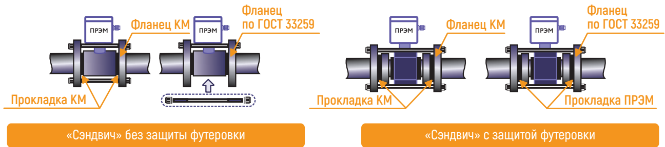
Рисунок 21. Варианты монтажа ПРЭМ исполнения «сэндвич»
