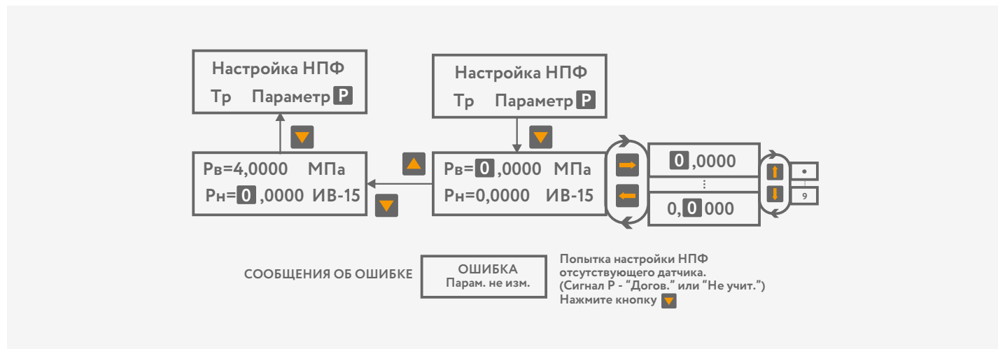
Рисунок 6.2 – Последовательность действий по настройке НПФ датчиков давления
