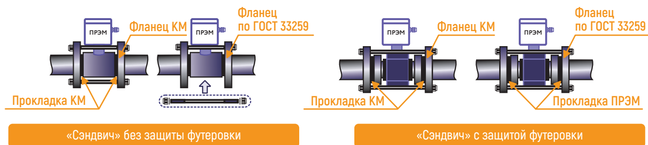
Рисунок 21. Варианты монтажа ПРЭМ исполнения «сэндвич»
